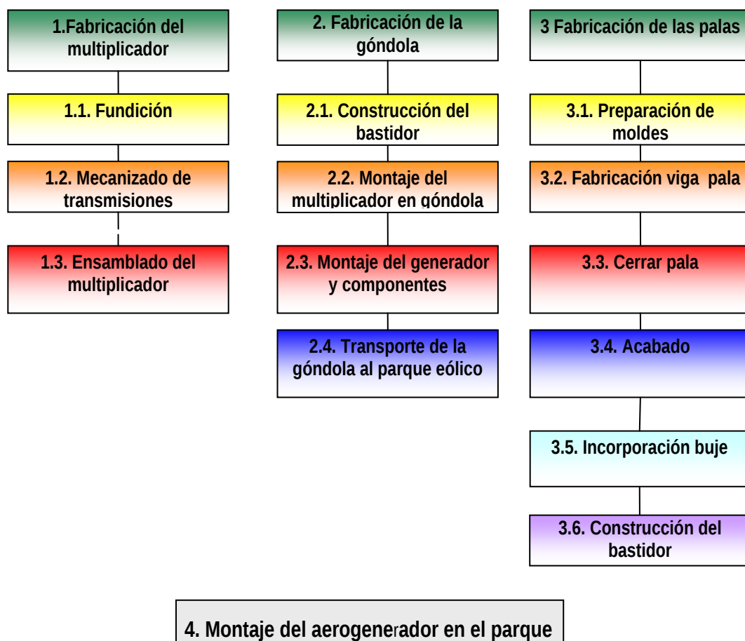
Figura 4.9. Etapas que intervienen en la fabricación de un aerogenerador
